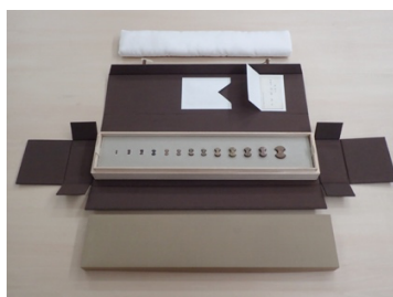
新たに製作した収納箱。分銅の形に合わせて土台を落とし込んだピロードの台を作成し分銅を固定した。
