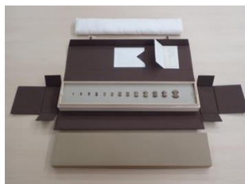
新たに製作した収納箱。分銅の形に合わせて土台を落とし込んだピロイドの台を作成し分銅を固定した。
